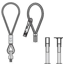
**3.1** De radius van het draagvlak van de kraanhaak moet groter zijn dan de kabeldiameter. De tophoek van de lus mag maximaal 20 graden zijn. Zie tekening.
