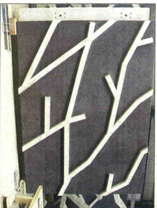
Voor de takken werd zelfverdrichtend beton gestort bovenop het antracietkleurige mengsel dat traditioneel verdicht moest worden.
